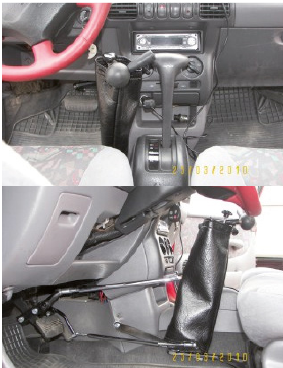
Fot. 1, 2. Hamulec pionowy z gałką gazu (arch. H. Centała)
