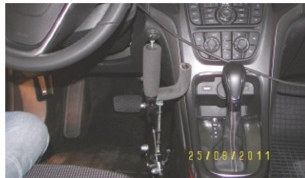
Fot. 8. Ręczny hamulec i gaz typu „ciągnij-pchaj” (arch. H. Centała)
