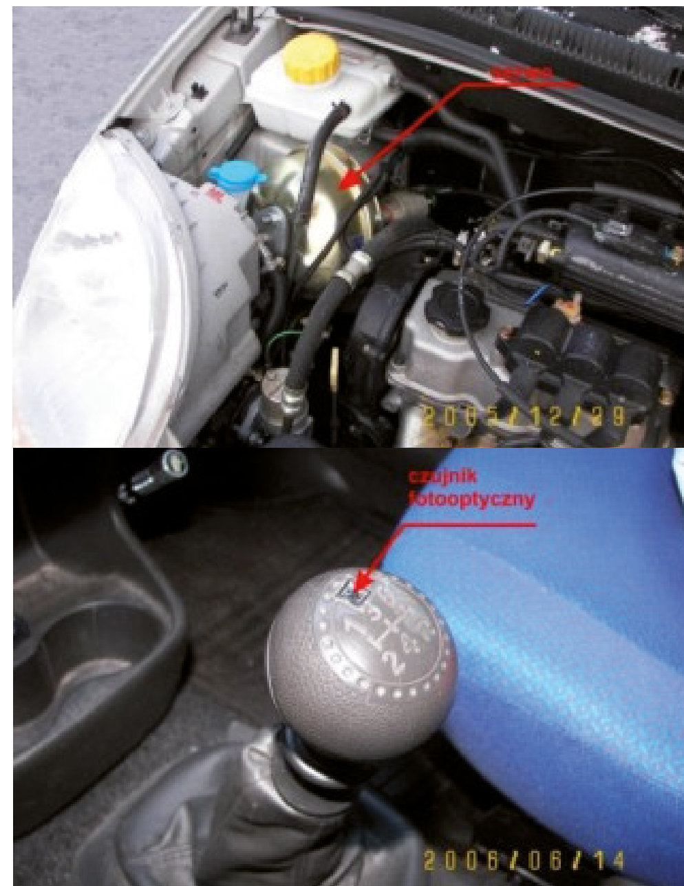
Fot. 3, 4. Sprzęgło automatyczne pneumatyczne (arch. H. Centała)
